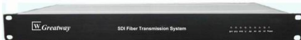
深圳广为 GSV 系列 SDI/ASI 标清数字视频光端机由光发送机 GSVT 和光接收机 GSVR 构成，用来传输 143、177、270、360、540Mbps 等五种速率的 SD-SDI 标清数字视频信号或 ASI 数字视频信号。GSVT 在电信号输入端配备了多码率电缆均衡器，GSVR 内置分配放大器输出 2 路 SDI（对 ASI 信号只有 1 路可用）。
